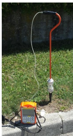
Foto 3: Izvajanje kontrole koncentracije plina v tleh
