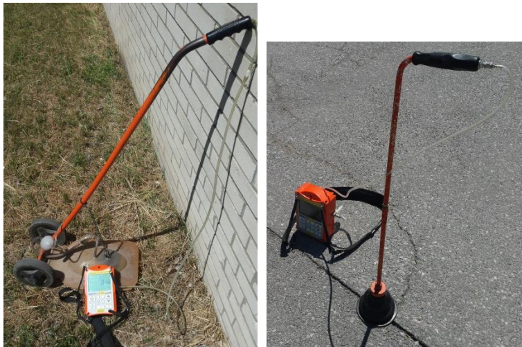
Foto 1-2: Izvajanje nadzemne metode zaznavanja uhajanja plina
